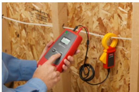
Induzione di un segnale con la pinza amperometrica se non vi sono conduttori nudi.
