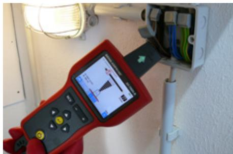
Individuazione dei cavi alimentati o non alimentati tramite rimozione della scatola di derivazione.
